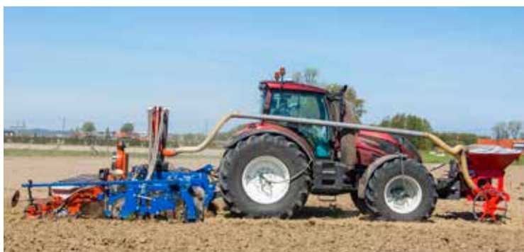
De zaaibedcombinatie van 6 meter met opgebouwde maïszaaimachine: 'minder rendement per ha per dag dan een gewone zaaimachine, maar we kunnen wel van 's morgens tot 's avonds doorzaaien.'
