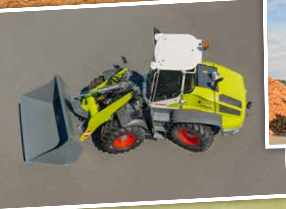
De Torion Sinus draait via een combinatie van knikstuur en fuseesturing op de achteras...
