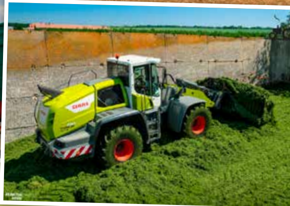
De Claas Torion 1914 met een werkgewicht van 19.500 kg is de zwaarste uit de wielladerreeks.
