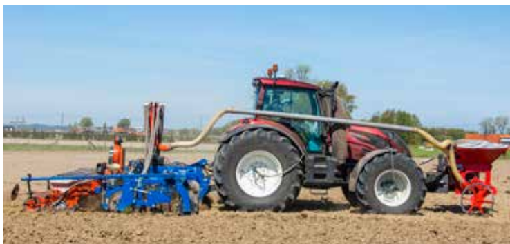
Le combiné de préparation de lit de semis avec semoir à maïs intégré permet de faire de plus longues journées.
