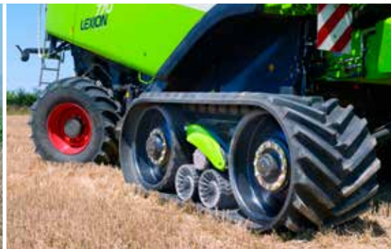
Bredere maaiborden en een grotere graantank hebben tot gevolg dat de zware maaidorser steeds meer van een rupsonderstel worden voorzien.
