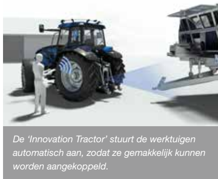
Dankzij de 'Pedestrian Detection' stopt de 'Innovation Tractor' zijn automatisch aankoppelmanoeuvre als er mensen in de weg staan.
