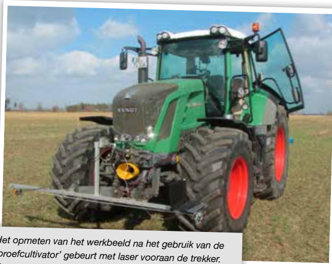
De uitbreiding van de single meetrail tot een triple meetbalk maakte het mogelijk om tijdens de proefrit op het veld tegelijk drie onafhankelijke metingen in één rit uit te voeren.
