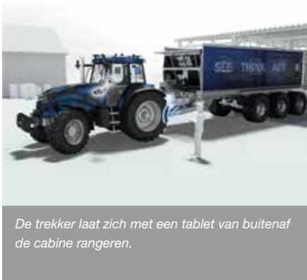
De 'Innovation Tractor' stuurt de werktuigen automatisch aan, zodat ze gemakkelijk kunnen worden aangekoppeld.
