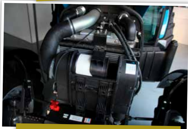
Daarom bouwen de importeurs in Zuid-Afrika nog een extra afzuig van inlaatlucht, bijvoorbeeld via een onderdrukstelsysteem dat in combinatie met de radiator van de koeling werkt.
