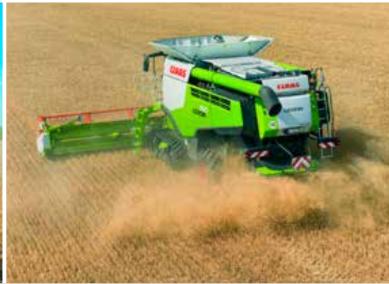
Een actieve stroverdeling via radiaalsystemen garandeert ook over grotere werkbreedtes een stabiele verdeling.
