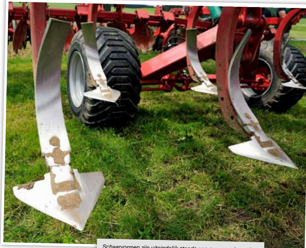
Schaarvormen zijn uiteindelijk steeds een compromis om het gebruik van bodembewerkingsmachines onder verschillende bodem- en weersomstandigheden mogelijk te maken.
