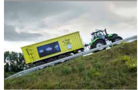
Met het tractiemanagement van de 'Innovation Tractor' kunnen hellingen tot 30% probleemloos worden genomen.
