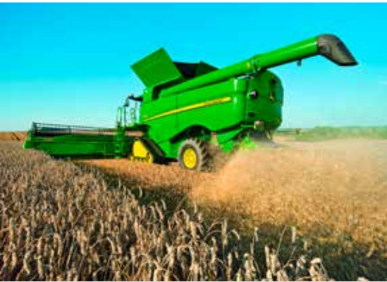
Een actieve stroverdeling via radiaalsystemen garandeert ook over grotere werkbreedtes een stabiele verdeling.
