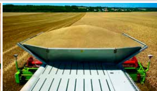
Wie met een machine met automatische stuurhulp en belastingafhankelijke snelheidsregeling rijdt, kan zich meer bezighouden met zaken als dorsinstellingen en graanverliezen.
