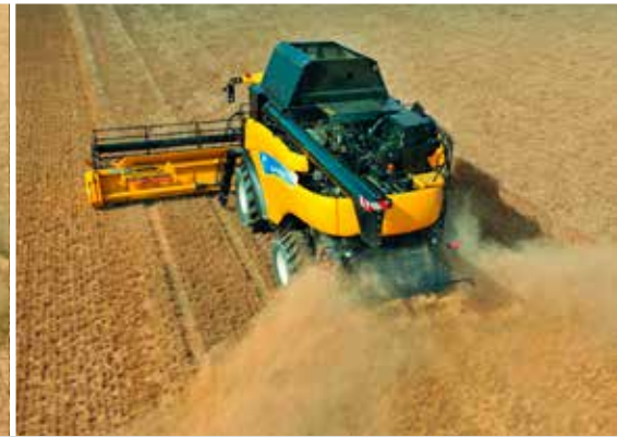
Een actieve stroverdeling via radiaalsystemen garandeert ook over grotere werkbreedtes een stabiele verdeling.
