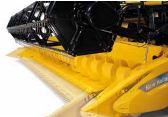
Variabele maaiborden verhogen de flexibiliteit bij het wisselen tussen koolzaad en tarwe.
