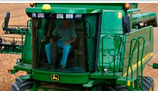
Wie met een machine met automatische stuurhulp en belastingafhankelijke snelheidsregeling rijdt, kan zich meer bezighouden met zaken als dorsinstellingen en graanverliezen.
