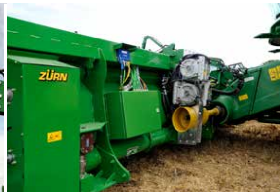
Achteraanzicht: in de plaats van een set tandwielen en riemschijven drijft de aftakas 3 generatoren voor de stroomvoorziening aan. ■
