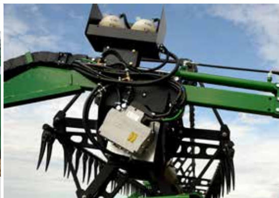
Boven de elektrische aandrijving voor de haspel zitten de reservoirs voor de waterkoeling van de elektrische componenten.
