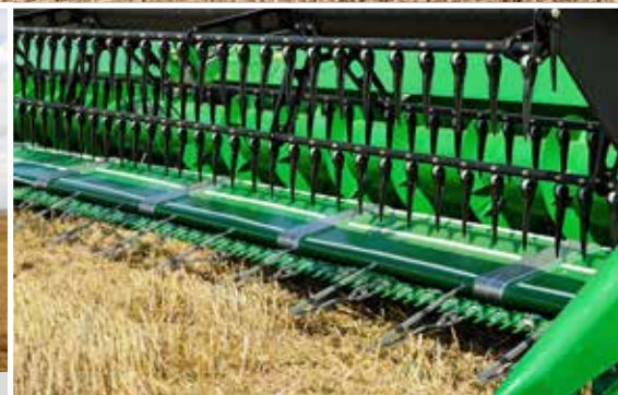
Elk van de 8 invoerbanden van het elektrisch maaibord wordt via een aparte elektrische aandrijving, los van de andere maaibordelementen, aangedreven en gestuurd.
