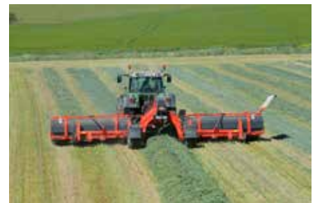
De Merge Maxx geeft de mogelijkheid om het gras over een breedte van maximaal 9,50 meter bij elkaar te brengen.
