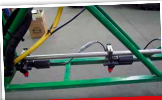
Het elektrische afsluitventiel van Lechler vormt een eenheid bestaande uit een ventiel, kabels en stekker en onderscheidt zich door een geringe stroomafname.
