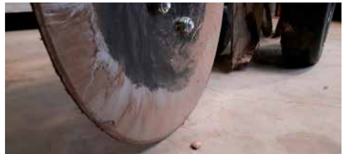
De snijdisc die de zode opensnijdt met daarachter het zaaikouter.
