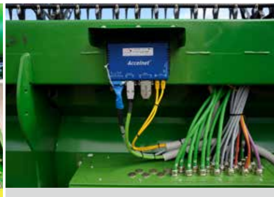
De acht aandrijvingen voor de invoerbanden worden ieder door een eigen elektronica aangestuurd.
