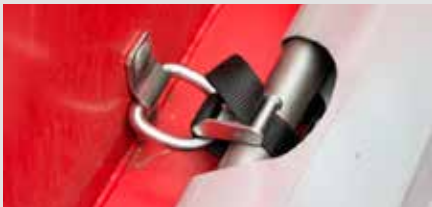
De mestzak wordt met haken vergrendeld aan de binnenkant van de kipper.
