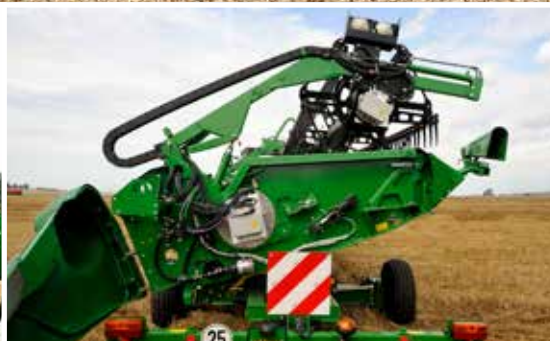
Aan de rechterkant van het elektrische maaibord zitten zowel de motoren voor de haspel en de rechter vijzel (elk 20 kW) als voor de rechter invoerband (0,75 kW). Links onder hangt de pomp voor de waterkoeling van de elektrische componenten.
