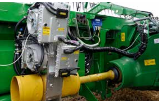
Bij de elektrische maaibordaanrijving blijft de aftakas nog altijd de koppeling tussen maaibord en maaidorser. Drie generatoren met een vermogen van totaal 60 kW zorgen voor de stroom voor het maaibord.
