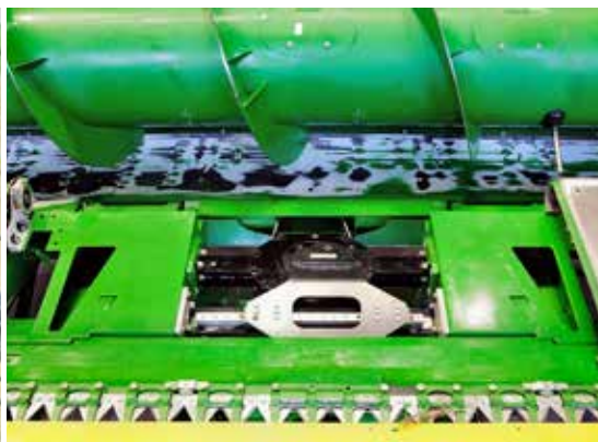
Zicht op de elektrische mesaandrijving van het i-Flow-maaibord.
