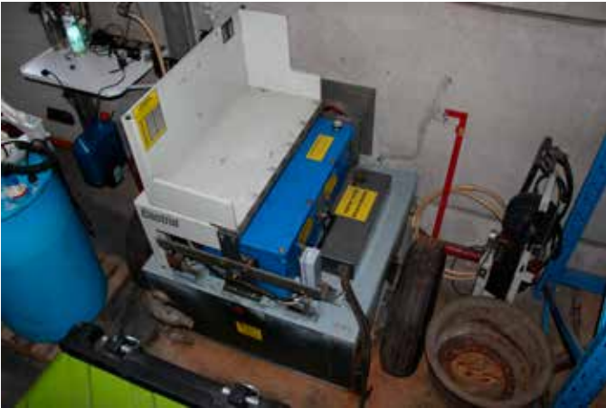
Het handige aan de vermogenstestbank is dat LMB Buysse daarmee ook de vermogens van de Claas-hakselaars kan testen (tot 650 pk).
