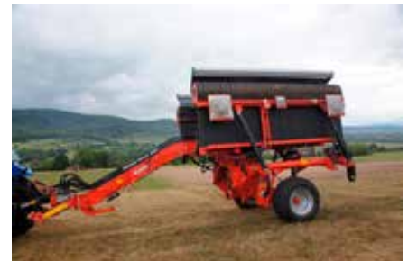
De bandhark bestaat uit twee delen van een pick-up.
